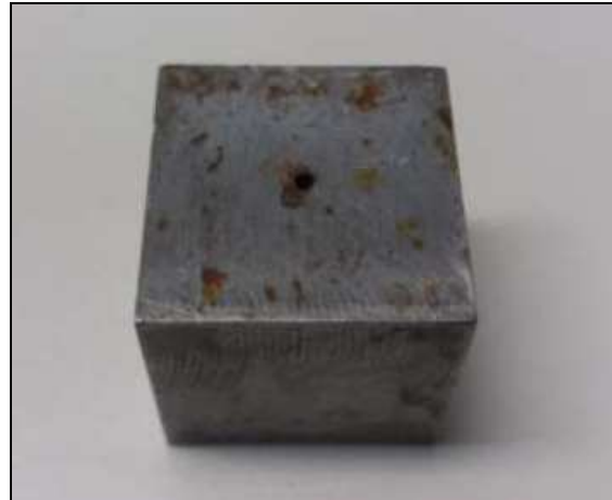
Figura 5 – Cubo utilizado na determinação da densidade livre
